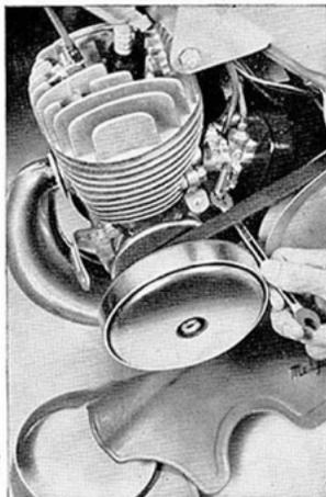
Graisser l'embrayage automatique (sur Mobylette sans changement de vitesses) à la CASTROLEASE CL, en cas de service fréquent (ville).
