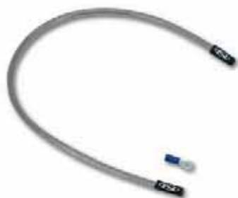
**Kit tresse inox pour mano de pression d'huile** Ces tresses sont aginées trasparente et sont pour les sondes de pression d'huile des EVO avec un seul fil. Se glisse facilement par-dessus le fil d'origine.
