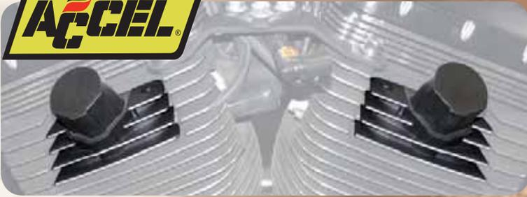
Bobines Accel stealth "Coil Over Plug" qui passe la bobine d'allumage directement sur la bougie.
