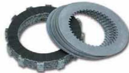
**722394** Pour Pro Clutch sur 1998-1999 Evolution Big Twins et 1999 au présent Twin Cam, contient 8 disques garnis et 9 disques lisses
