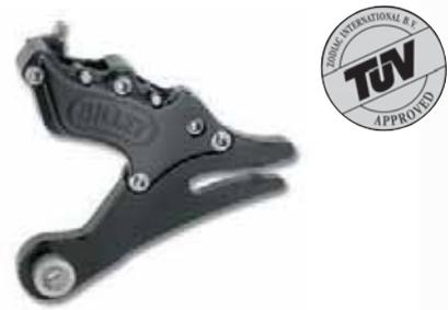
Etrier arrière 4 pistons, pour Dyna de 2000-2005 avec avec disques de taille d'origine en 11 1/2".
