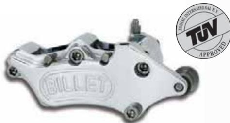
Etrier arrière 4 pistons, pour 1973-1983 Big-Twin boîte 4, remplace l'étrier banane, l'étrier doit être utilisé avec le support ZPN144031 et un disque de 10".
