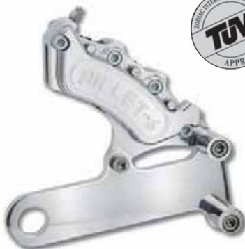
Etriers arrière 6 pistons "Mini 6", pour FLH et FLT de 1984-1999 avec disques de taille d'origine en 11 1/2".
