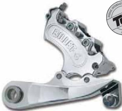
Etriers arrière 6 pistons "Mini 6", pour 2000-2007 Softail avec disques de taille d'origine en 11 1/2", sauf 2006-2007 FXST, FXSTB et FXSTS
