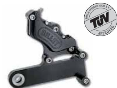
Etrier arrière 4 pistons, pour FXR de 1982-1994 avec disques de taille d'origine en 11 1/2".
