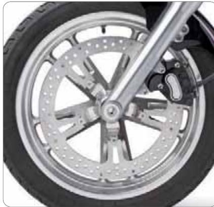
**A02964** Kit disque 15", pour l'avant gauche ou droit des 2006 au présent V-Rod et 2006 au présent FLD, FXD et FXDL avec roue à rayons de 19" ou plus
