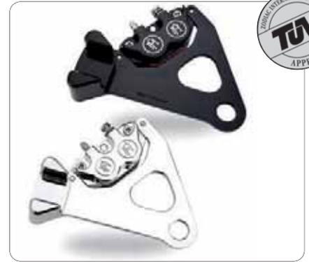
Pour Sportster de 2005 au présent sauf XR 1200. Doit être installé avec un disque de 11 1/2" sur les modèles de 2011 au présent. Aussi pour 2004 Sportsters si le passage de l'axe de roue est alésé de 25mm à 1" (25.4mm)
