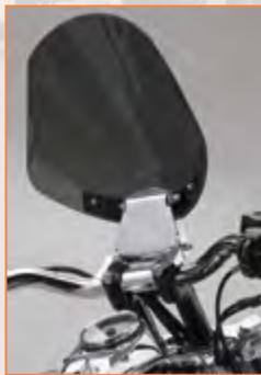
La bride de montage sur mesure entièrement réglable exploite l'action du pivot double pour permettre le positionnement continu afin de répondre aux besoins de différents motards ou conditions météo. Une simple clé suffit - enfin une solution simple dans un monde complexe.
