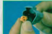
4 Avec tous les contacts installés, insérez la cale orange de sorte à ce que la flèche pointe vers le mécanisme de verrouillage extérieur. La cale orange va s'enclencher. Les cales rectangulaires n'ont pas d'orientation précise. Ils peuvent être placés dans le sens désiré. REMARQUE : La barrette de connexion est illustrée - employez la même procédure pour la fiche.
