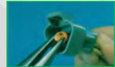
1 Retirez la cale orange en utilisant des pinces pointues ou fil plié en boucle pour retirer la cale.
