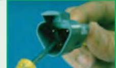
2 Afin d'enlever les contacts, tirez doucement sur les fils et déverrouillez en même temps le doigt de verrouillage du contact à l'aide d'un tournevis.
