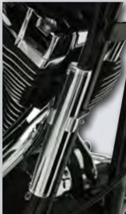
2. Le petit actionneur chromé (uniquement 7" de haut), monté sur le tube de cadre avant droit, reçoit le signal de l'interrupteur de guidon et ouvre/ferme les inverseurs via des câbles haute performance.
