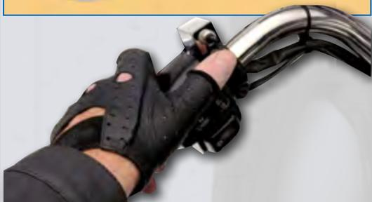
1. L'interrupteur à levier pratique monté sur le guidon vous permet des transitions instantanées entre les modes bruyant et calme.
