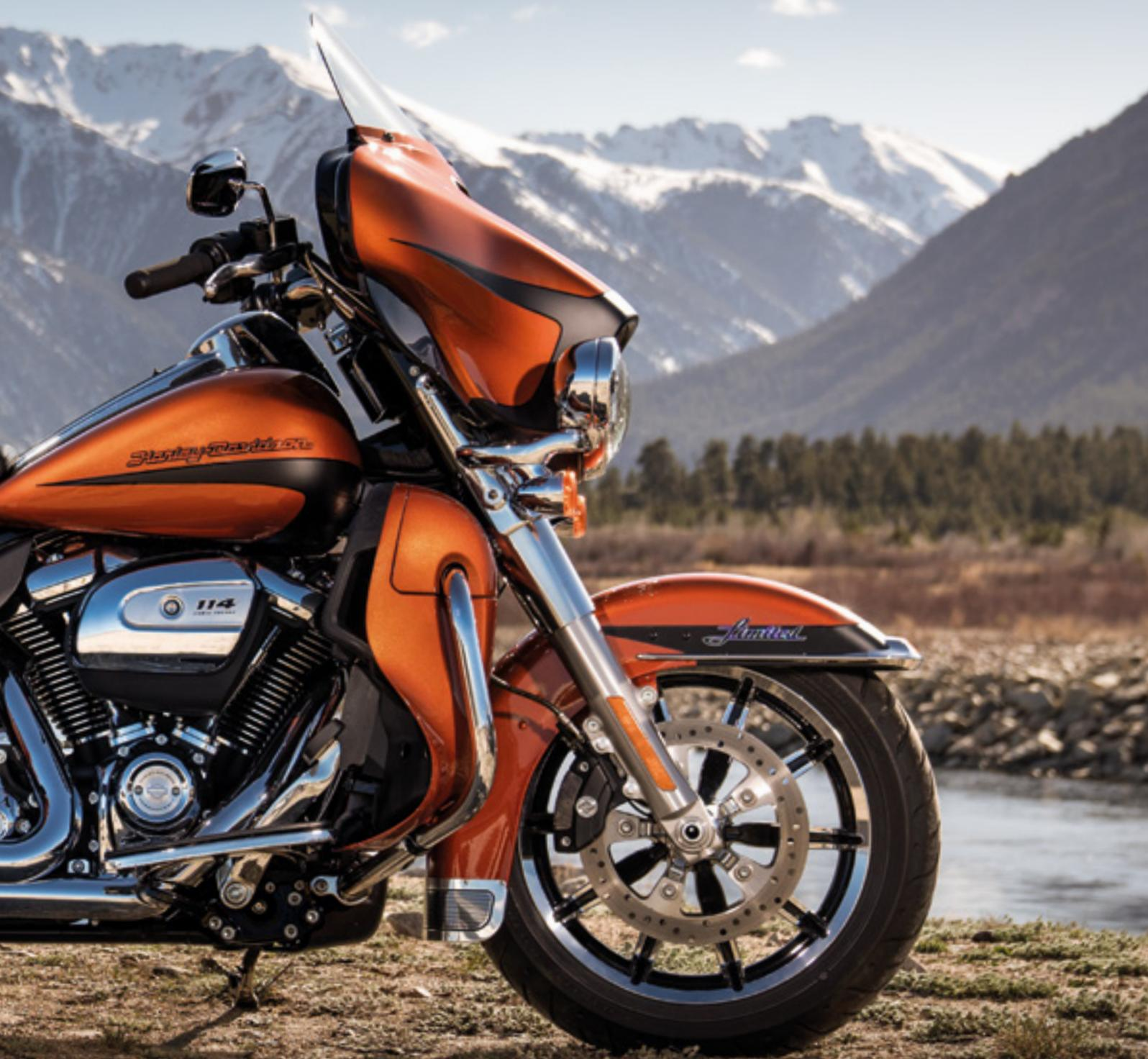
**ULTRA LIMITED LOW /** Vous n'avez pas besoin d'être grand en taille pour piloter une moto qui est grande en réputation Touring. Le modèle Ultra Limited Low dispose de suspensions avant et arrière abaissées, offrant la hauteur de selle la plus basse de la famille Touring H-D®, à 675 mm du sol. La béquille latérale est encore plus facile d'accès et les poignées ont un diamètre réduit. Tout est à votre portée.
