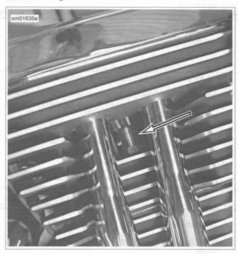
Figure 4-11. ET Sensor Location
